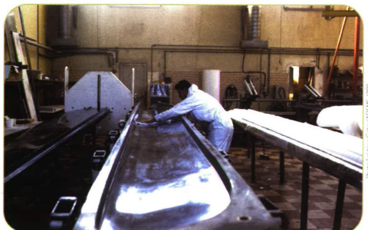
Fabrication de pales d'éoliennes
